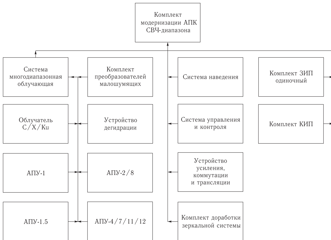
Рисунок. Структурная схема универсальных комплектов модернизации АПК на базе антенных установок ТНА
